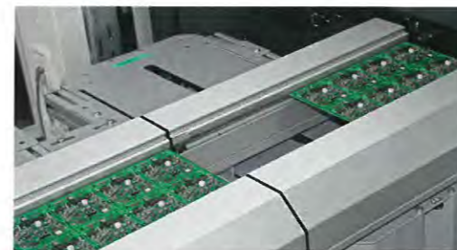
Bei der Herstellung elektronischer Leiterplatten kommt eine spezielle SMD-Bestückungsanlage zum Einsatz, mit der alle benötigten Systemkomponenten auf die Oberfläche aufgebracht werden.
