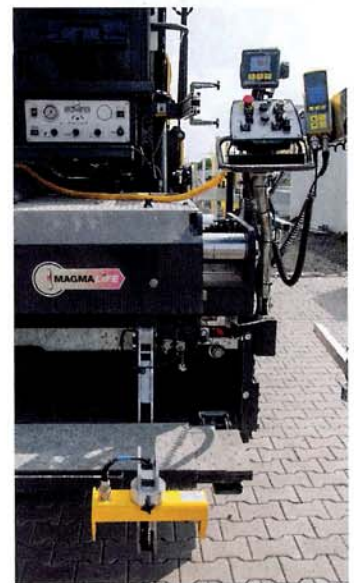
Pave-TM liefert eine millimetergenaue Messung und eine simultane Anzeige der aktuellen Einbaustärke.
