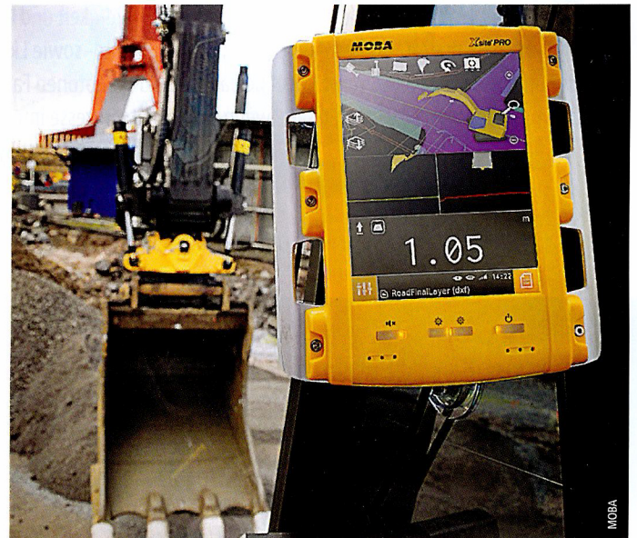
Baggersteuerung Xsite Pro 3D auf einer BIM-Baustelle im finnischen Tampere.
