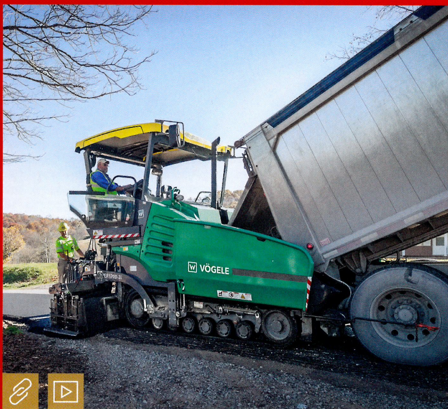
Brandneu von Vögele ist der Raupenfertiger Super 1700-3i für hohe Einbauleistungen bis 700 t/h und ein breites Einsatzspektrum; der Zusatz „i“ („intelligent emission control“) weist auf die ausgeklügelte Abgasnachbehandlung der Fertiger hin. Bild: Vögele
