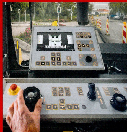
Bei den neuen Fertigern von Volvo CE optimiert das Electronic Paver Management (EPM) die Bedienung; mit dem „Settings Manager“ lassen sich jederzeit wichtige Einstellungen speichern. Bild: Volvo CE
