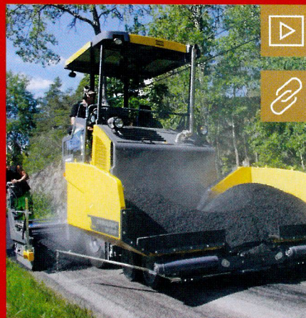
Beim neuen Dynapac SD1800W für bis zu 350 t/h Einbauleistung und 0,7 bis 4,7 m Arbeitsbreite überwacht der „PaveManager 2.0“ den Einbauprozess und optimiert den gesamten Arbeitsablauf. Bild: Dynapac
