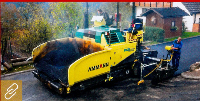
Das fein dosierbare hydrostatische Getriebe des Ammann AFT 500 erlaubt besonders sanftes Anfahren und Anhalten sowie sehr konstante Geschwindigkeit. Bild: Ammann
