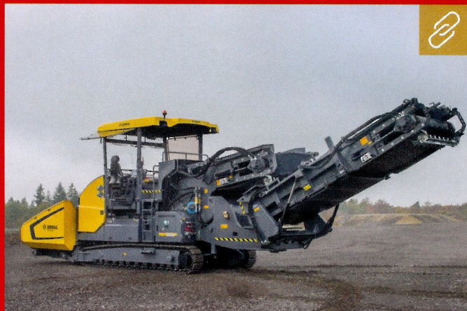
Immer häufiger werden zwischen Lkw und Fertiger sogenannte Beschicker (Feeder) für möglichst konstanten Materialfluss und ruckfreies Arbeiten eingesetzt, hier ein Bomag-Beschicker BMF2500. Bild: Bomag
