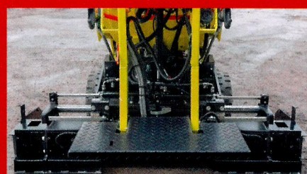
Der neue Mini-Radfertiger AFW150-2 von Ammann ist dank Seitenfreiheit, nur 0,8 m innerem Wendekreis und 250 bis 1.650 mm Einbaubreite ideal für Geh- und Radwege, Ausbesserungsarbeiten und bei Leitungs- und Versorgungsgräben. Bilder: Ammann
