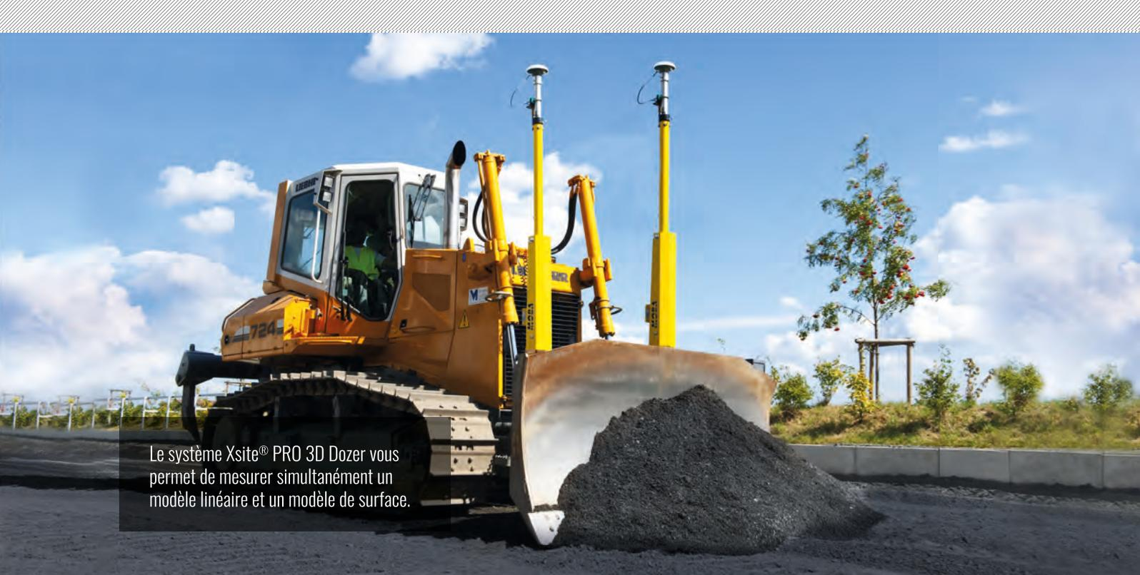
Le système Xsite® PRO 3D Dozer vous permet de mesurer simultanément un modèle linéaire et un modèle de surface.
